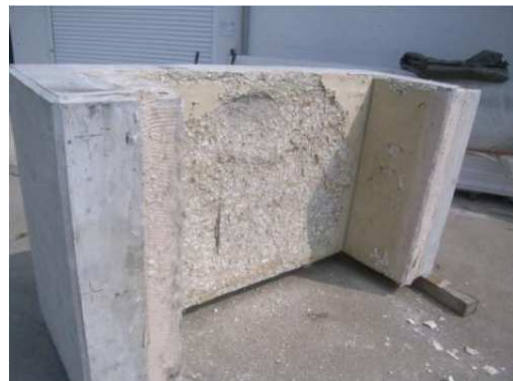
Abbildung 4: Probekörper aus Referenzbeton (mit PP-Fasern) nach Großbrandversuch [3]
