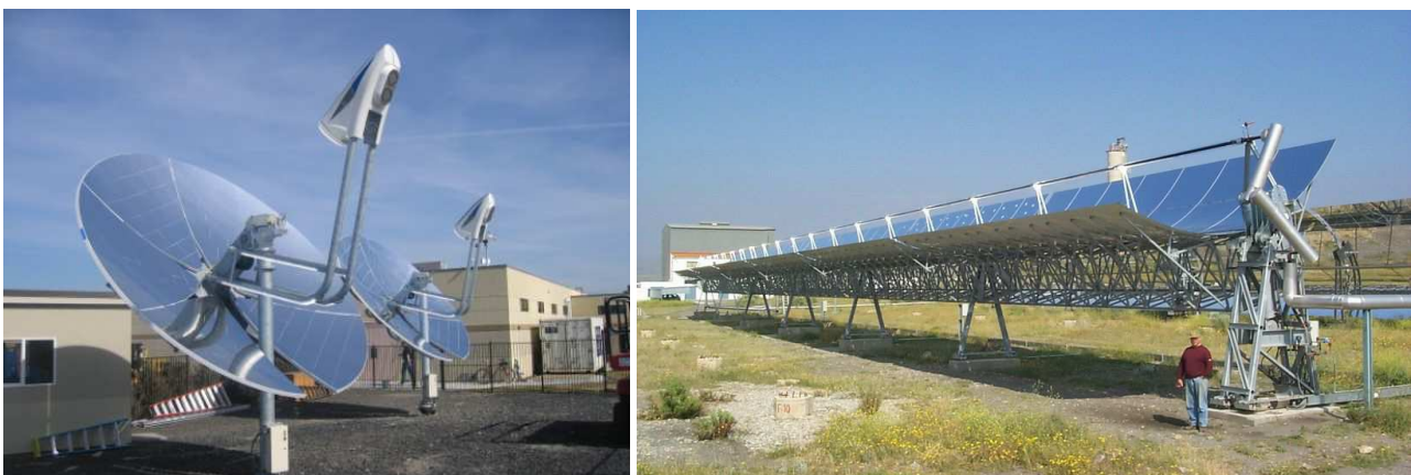
Abbildung 1: Infinia PowerDish mit Gore-Facetten und der Parabolrinnenkonzentrator Eurothrough
