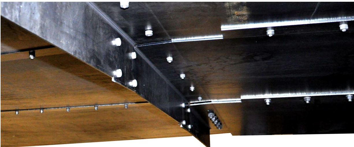
Abbildung 17 Probeaufbau von 3x3 Schindeln und 2x3 Randträgerbelchen
