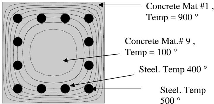
Fig 16 : Composite column section 30x30 cm
