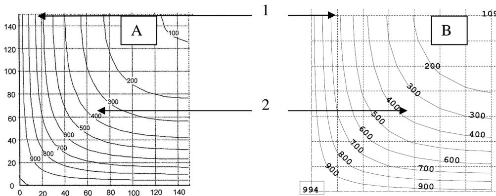
Bild 13: Temperature zones acc. to A) EC2
